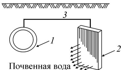
**Рис. 10.21.** Схема протекторной защиты:
